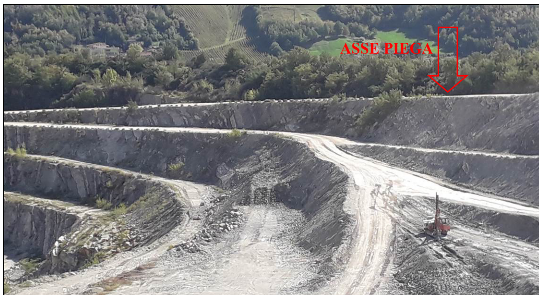
Fotografia 4.2: individuazione dell'asse della piega individuata nel cantiere Albarola.
